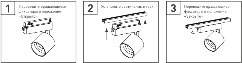
Рис. 3. Установка светильника в трек
