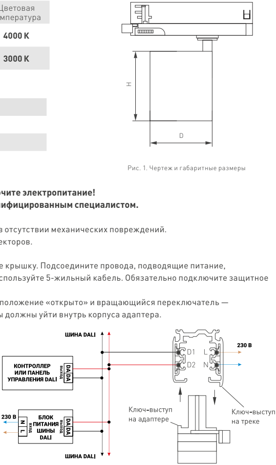
Рис. 2. Схема подключения светильников с управлением DALI
