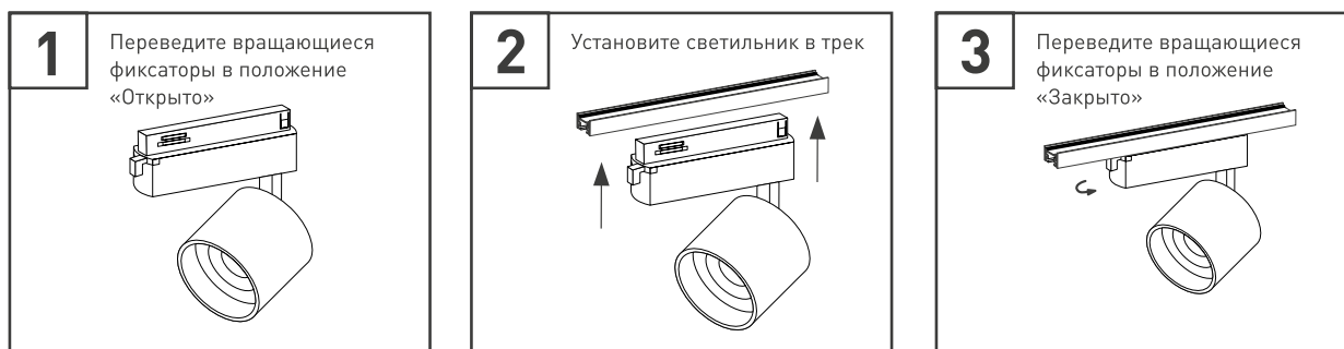
Рис. 3. Установка и подключение светильника
