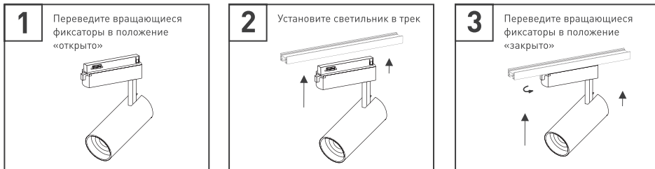
Рис. 3. Установка и подключение светильника
