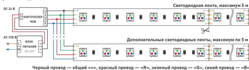
Схема 1. Подключение нескольких светодиодных лент с одной стороны
