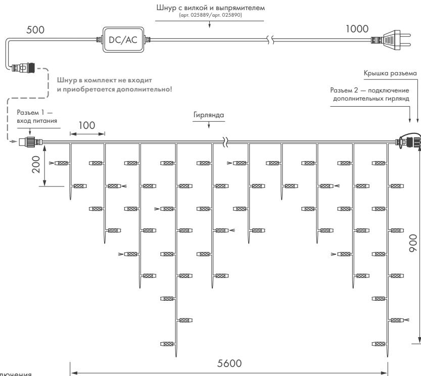
Рисунок 1. Схемы подключения.
