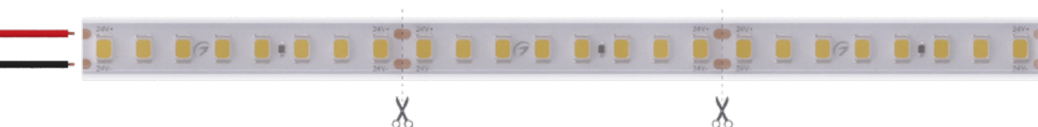
Схема 1: подключение нескольких светодиодных лент с одной стороны
